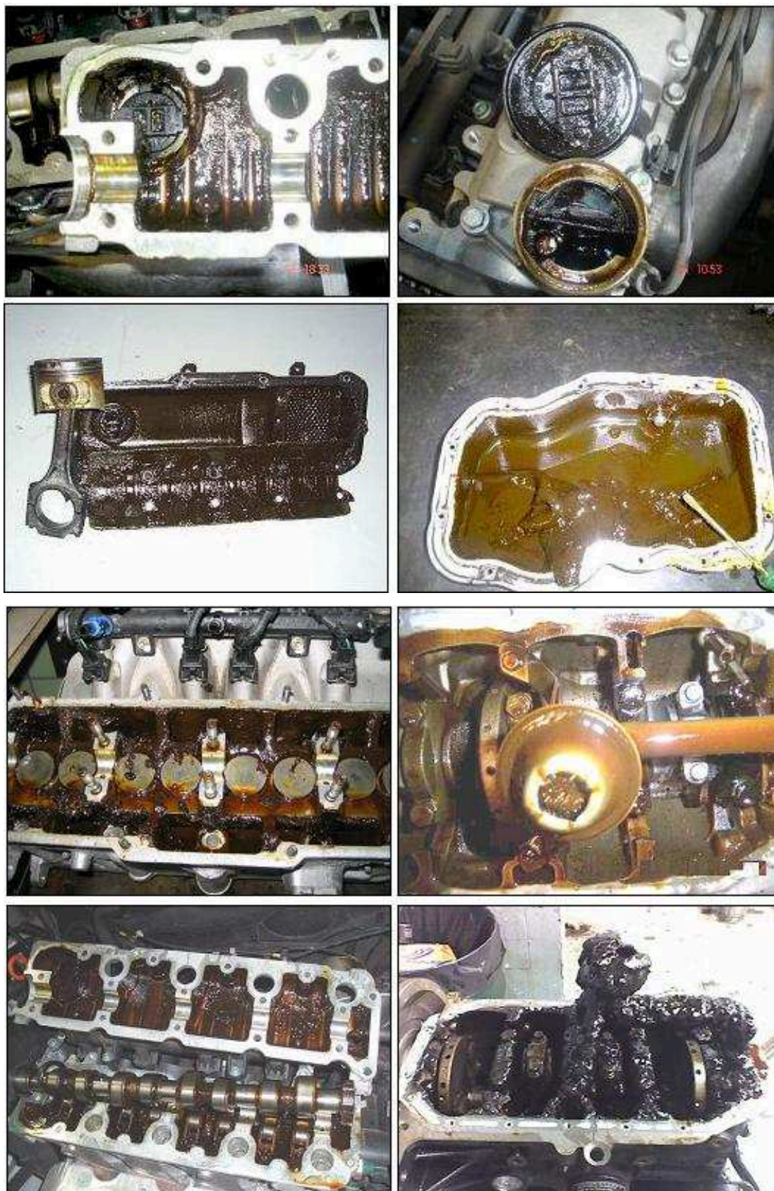
Рис. 01 - Примеры образования масляного шлама в двигателе.
