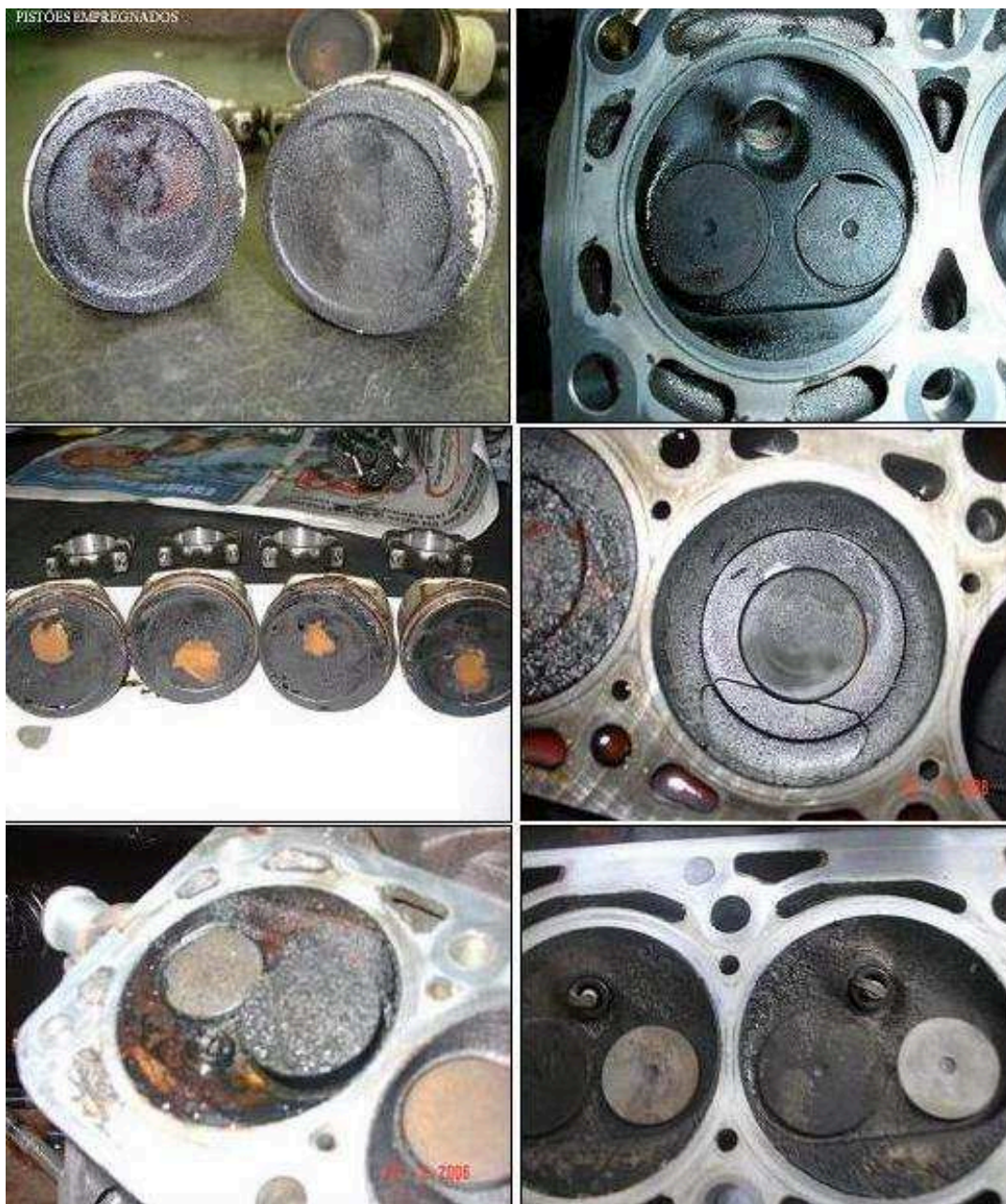
Рис. 02 - Примеры закоксовывания ГБЦ и поршней из-за использования фальсифицированного или загрязнённого топлива.
