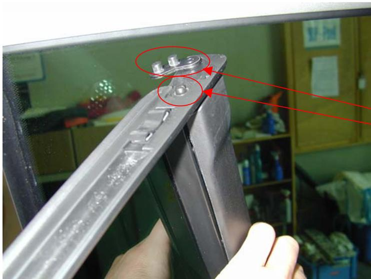
Монтаж в обратной последовательности. При этом направляющие цапфы отвести наружу. Чтобы штифт фиксатора оставался утопленным, установить "бабочку" фиксатора в положение 'открыто'.
