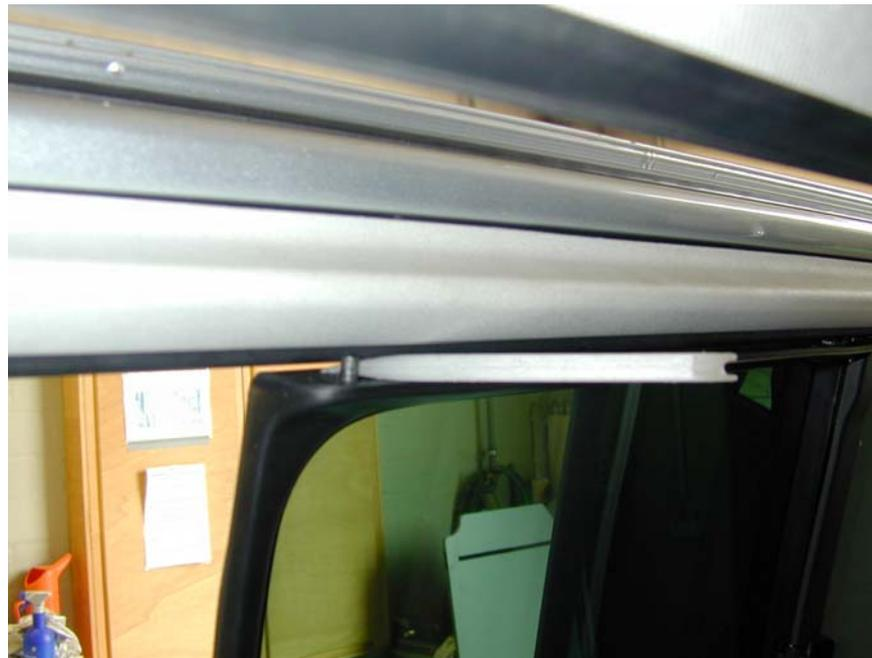
С помощью пластмассового клина осторожно сдвинуть верхнюю часть рамы окна вверх, так чтобы высвободить цапфу сдвижной части из направляющей рамы.
